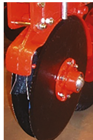
Дводисковий висівачий модуль з дисками різного діаметру (15,5 та 16 дюймів) і малим кутом
