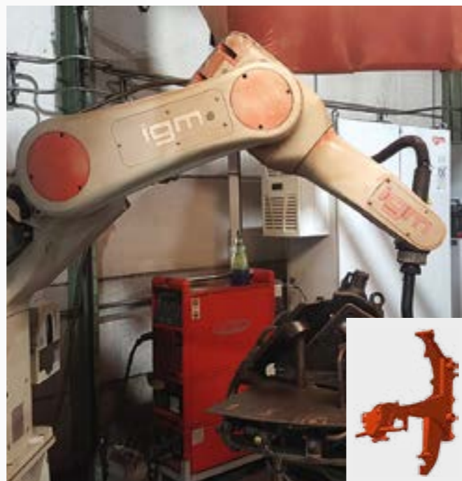
Роботи-зварювальники пристосовані до різних типів робочих деталей: - великих, діаметром 3-4 м (ліворуч) - малих, вагою 100 кг (праворуч)
