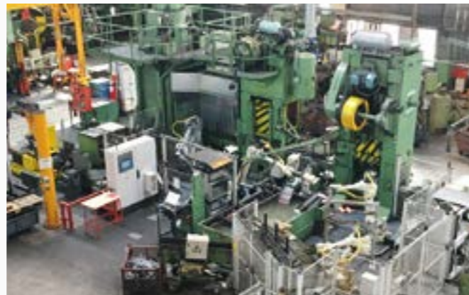
2017-й: високороботизований процес (роботизоване пресування, транспортування деталей, інтегроване гартування)
