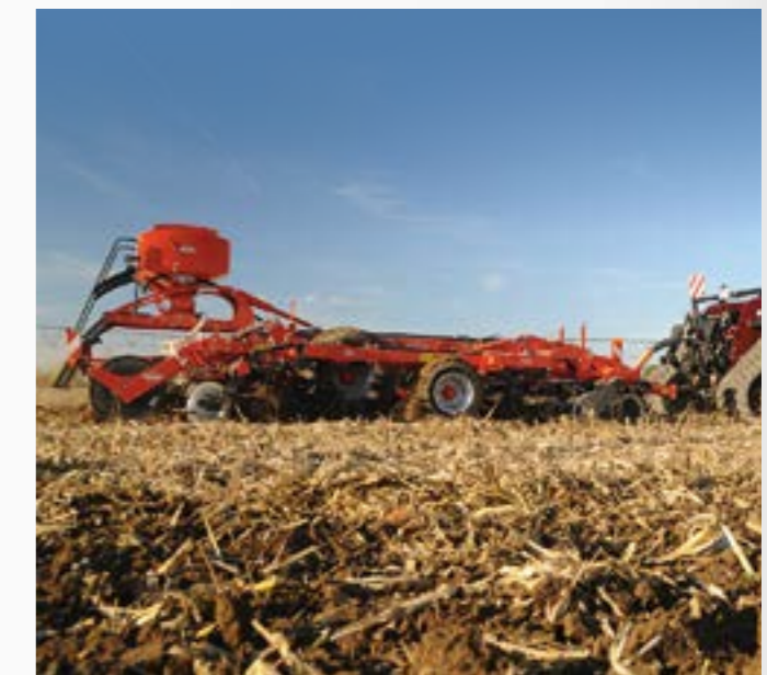
Дисколаповий глибокорозпушувач PERFORMER 6000: 4 операції за один прохід (подрібнення, змішування або розпушування, вирівнювання, ущільнення)
